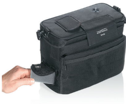
Figura 21. Retirada del filtro de entrada de aire para limpiarlo.
