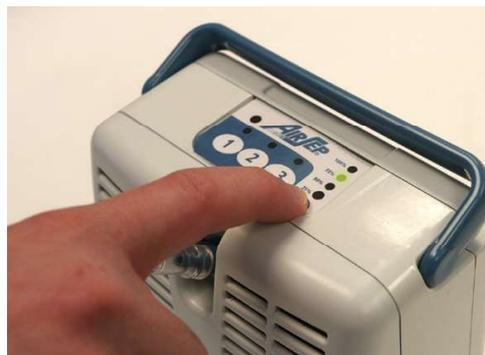
Para comprobar la carga de la batería cuando no está instalada en el concentrador FreeStyle o FreeStyle 5, ponga la batería boca arriba y pulse el botón TEST. Los indicadores luminosos de carga de la batería (25 %-100 %) se iluminarán en la parte derecha del botón TEST para indicar el nivel de carga.
